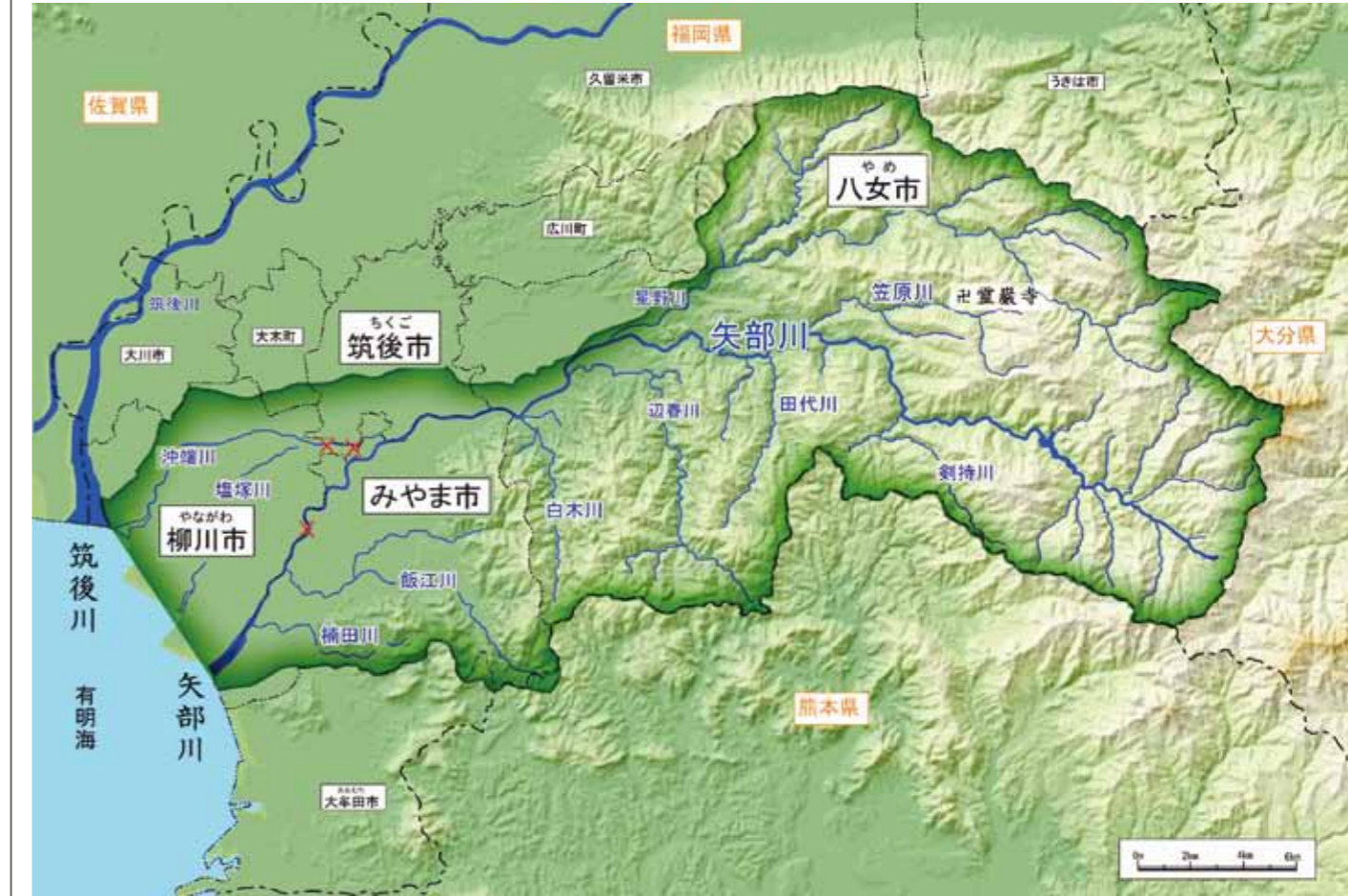
図1 矢部川流域図 矢部川は、幹川流路延長61km、流域面積647km 2 の一級河川です。×は決壊箇所
